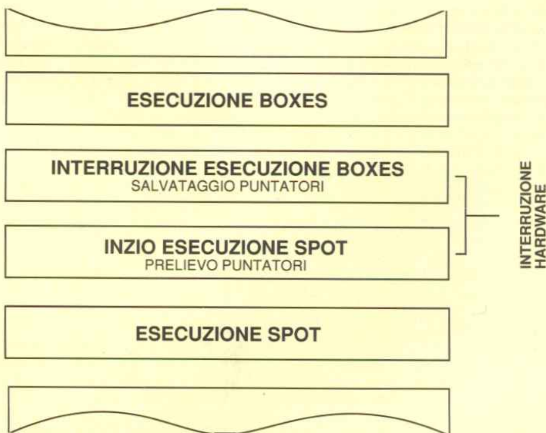
Figura 2. Sequenza dell'esecuzione di due processi multitasking.
